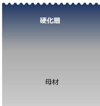
ショットピーニングにて表面に微細な凹凸を形成。これにより**摩擦係数が低減**します。
